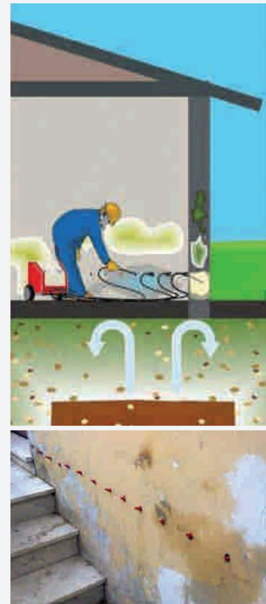
Ad una quota di 8 cm sopra il piano del pavimento, si praticeranno una serie di fori  $\varnothing$  12mm e profondi circa 2/3 cm nel muro. In questi fori si inseriranno a pressione apposite valvole di non ritorno (**PACKER**) e con apposita pompa da iniezione a pressione e portata variabile si immetterà l'idrorepellente **dws1000®**, esente da solventi, inodore ed ininfiammabile, in microemulsione, in ragione di lt.0,16 per cm di spessore per m.l. (consumo medio stimato su tufo).
