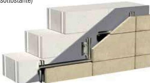
In questo caso, prima di ancorare la sottostruttura alla facciata, applicare MULTICEM o INCOLLARASA non armato. Con tasselli idonei (es. X3, SXRL o FIS V) fissare alla struttura dell'edificio e alla muratura il sistema di ritenuta scelto (sottostruttura metallica, sistema puntuale, sistema misto), quindi posare le lastre di rivestimento.
