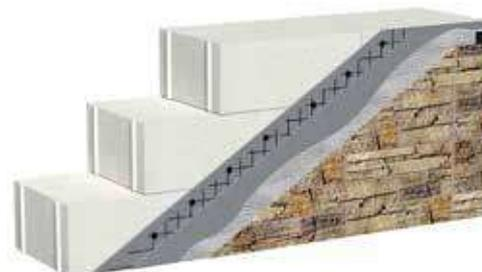
Avvenuta la completa maturazione di MULTICEM o MALTACOLLA M10 armati (30 gg.), incollare il rivestimento esterno con collante elastico idoneo per il tipo di rivestimento, tramite il sistema della doppia spalmatura. Si consiglia l'uso di lastre/piastrelle di spessore e formato contenuto e l'utilizzo di ganci di ritenuta di sicurezza per rivestimenti leggeri (vedi pag. 23).
