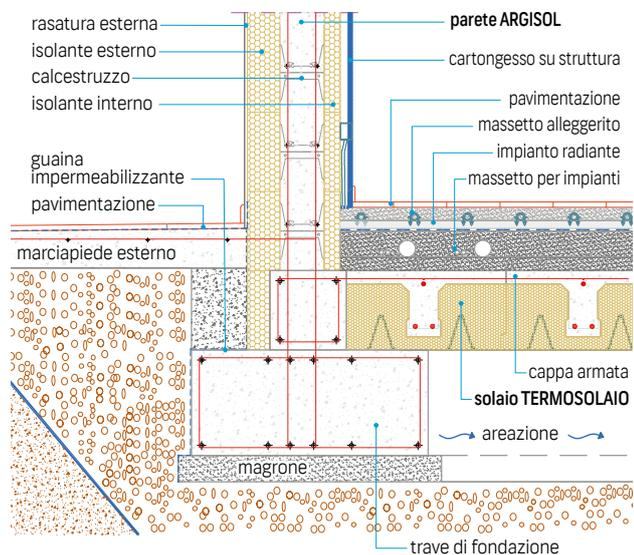
Cordolo TERMOSOLAIO su parete ARGISOL e terrazzino in c.a.
