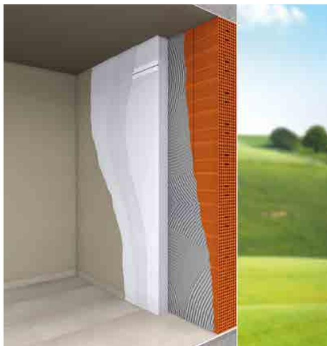
Sistema preaccoppiato, costituito da una lastra di cartongesso di altissima qualità con un elevato potere di isolamento acustico e resistente al fuoco, ed un pannello in polistirene espanso sinterizzato.
