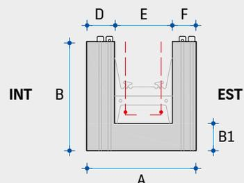
Utilizzo: l'elemento viene utilizzato a formazione degli architravi in sommità delle aperture come porte e finestre.
