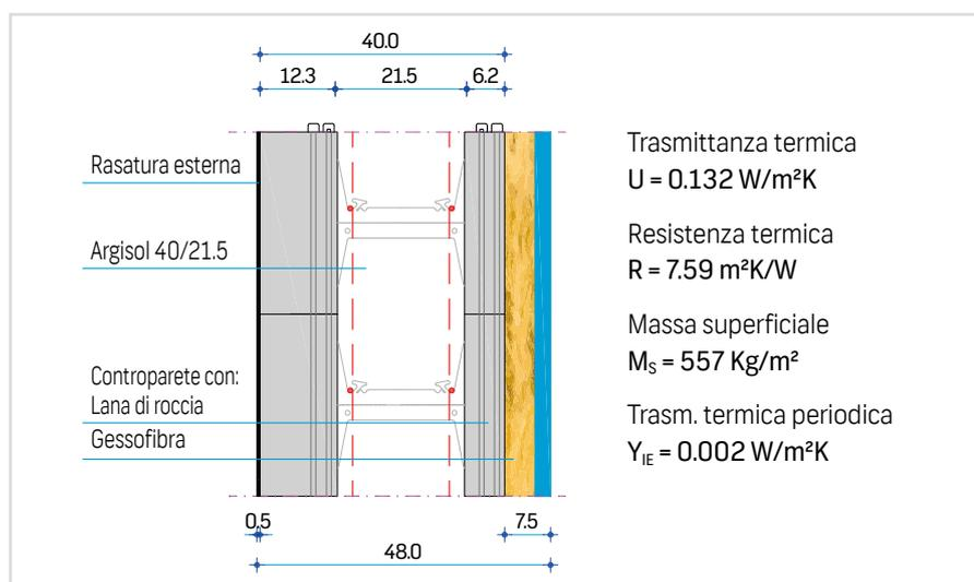
Sarà cura del progettista termotecnico l'adeguata progettazione della parete a seconda della zona climatica, della tipologia di blocco e delle finiture scelte.
