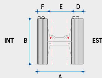
**H=30** Utilizzo: l'elemento viene utilizzato a formazione degli angoli concavi del fabbricato.
