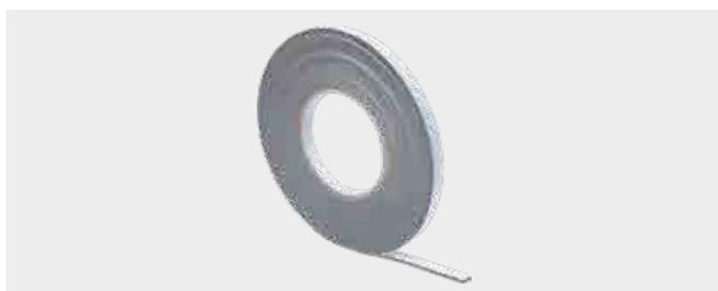
Nastro di guarnizione autoadesivo ed autoespandente in poliuretano espanso precompresso. Utilizzato per la sigillatura in corrispondenza di giunti tra sistema a cappotto e serramenti di porte e finestre, balconi ecc. Le certificazioni BG1 garantiscono permeabilità al vapore acqueo, resistenza a pioggia e pressione del vento.
