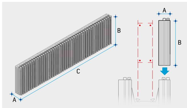
Utilizzo: l'elemento viene utilizzato a chiusura laterale del cordolo solaio. L'elemento viene fissato al blocco inferiore tramite il listello reggisponda.
