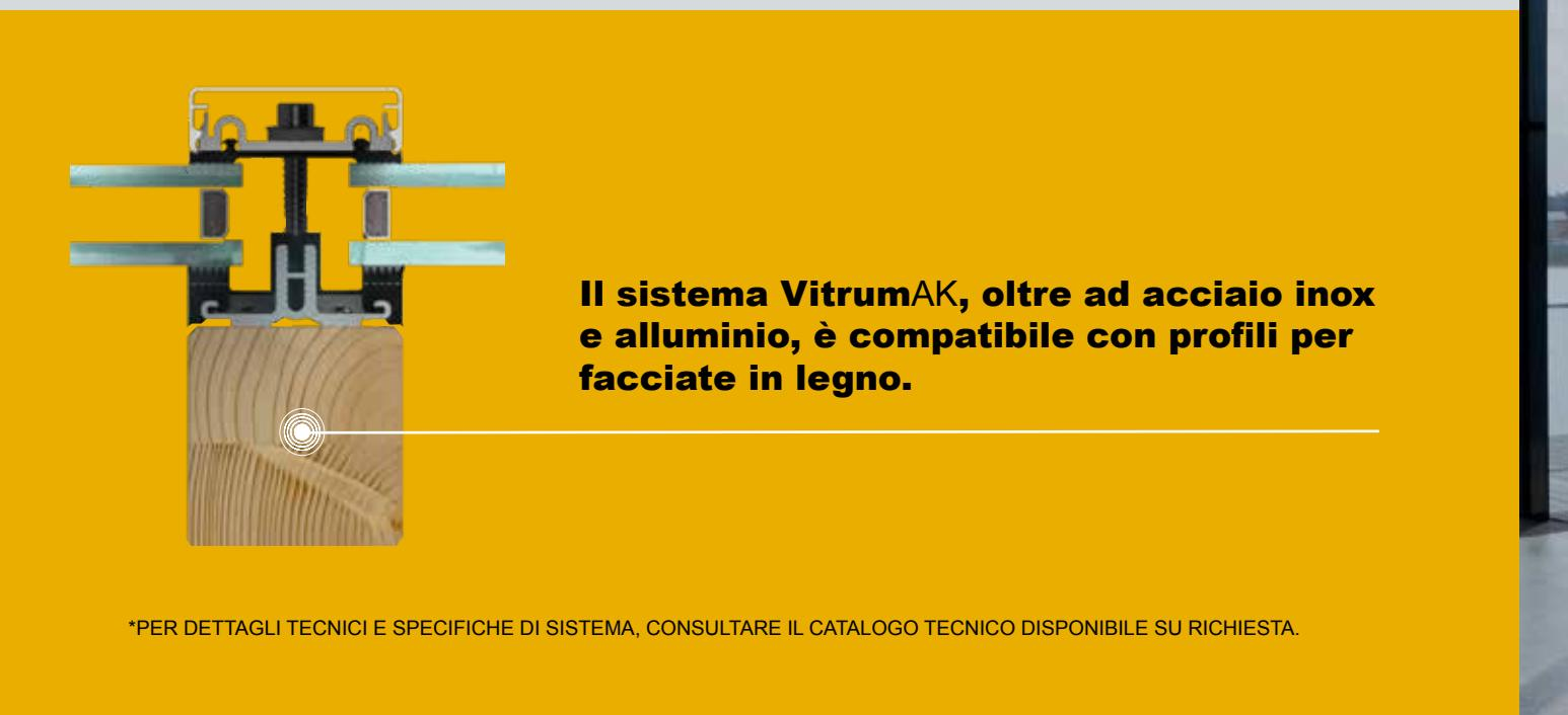
**Il sistema VitrumAK, oltre ad acciaio inox e alluminio, è compatibile con profili per facciate in legno.**
