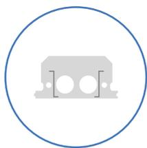
Il solaio Plastbau®-Metal è un pannello cassero a rimanere in polistirene espanso sinterizzato EPS (UNI EN 13163), autoportante prima del getto sino ad un massimo 2,40 ml, di larghezza nominale pari a 60 cm, a geometria ed altezza variabile in funzione della luce della campata con coibentazione termica integrata, utile alla formazione di solai monodirezionali armati e gettati in opera.
