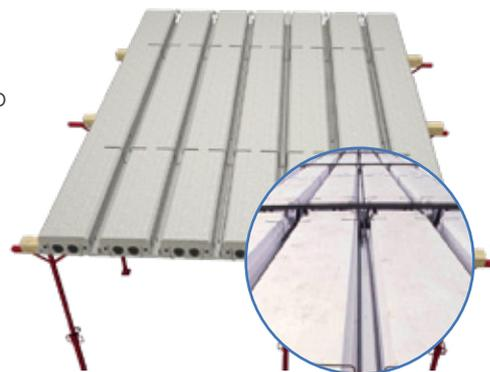
Completato il posizionamento dei pannelli procedere collocando l'accessorio ad "Ω" all'interno dei travetti e i relativi ferri d'armatura.
