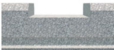
Per impedire la deformazione trasversale per luci superiori a 5 metri, è possibile ricavare la sezione necessaria per la corrispondente trave rompitratta asportando parte della porzione superiore di EPS. Tale operazione eseguibile anche in cantiere per mezzo di semplici attrezzature edili non riduce le proprietà isolanti dei pannelli stessi.
