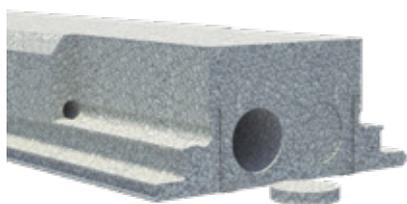
I pannelli cassero Plastbau®-Metal sono forniti con tappi copritestata da 120 mm a chiusura delle cavee longitudinali, in modo da non permettere al conglomerato cementizio di riempire le stesse evitando sprechi di calcestruzzo ed aggravio di peso.
