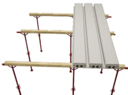
Dopo aver montato i rompitratta provvisori in direzione perpendicolare a quelli dei (profili a Z) posizionare i pannelli Plastbau®-Metal seguendo le pertinenti procedure di sicurezza. Accostare i pannelli uno accanto all'altro in modo da ricavare la sezione strutturale del solaio.
